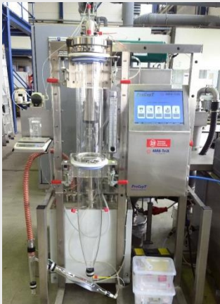
Die Abbildung zeigt einen Sprühtrockner zur Herstellung definierter Granulate und Aggregate.
